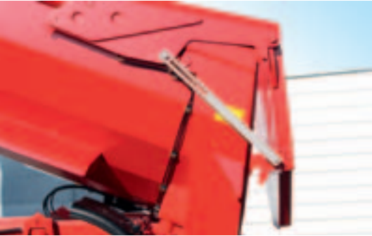
Langue à sable afin de limiter la course d'oscillation du hayon arrière à ouverture hydraulique.
