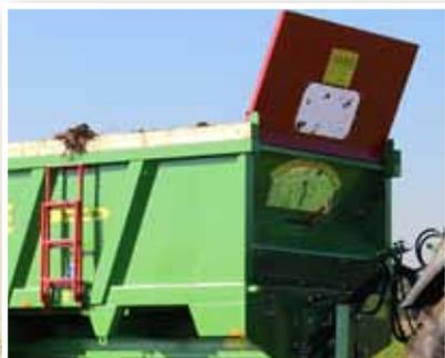
Grille de protection avant, rehausse avant transparente et échelle repliable sur le côté droit. Arêtes de raclage en bois.
