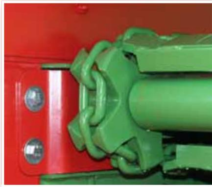
**Gratte-fond** Arbre du fond convoyeur triplement soutenu. Autonettoyage de qualité via le déflecteur dans chaque noix de chaîne.
