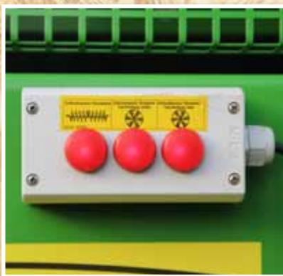
Surveillance de la vitesse de rotation des hérissons et de la table d'épandage avec dispositif d'arrêt du fond convoyeur.
