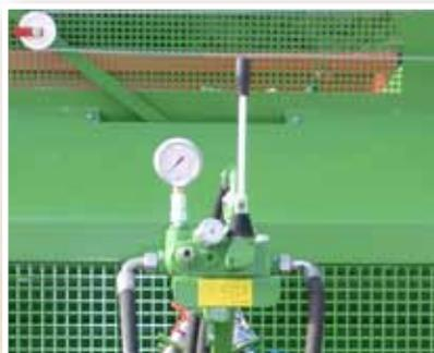
Commande manuelle avec régulation continue de la vitesse du fond convoyeur, montée sur le timon.
