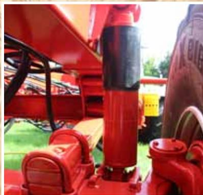
Châssis avec suspension hydraulique, avec 1er essieu relevable.
