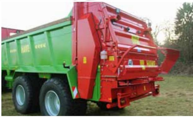
**Volet sur hotte** Réglage manuel simple de la hauteur et de la largeur de la partie inférieure du caisse pour l'adapter aux différentes matières à épandre. Optimisation du flux des matières sur la table d'épandage pour une répartition précise. Cale d'épandage pour améliorer la précision de l'épandage en cas de matière légère (compost, fientes séchées, etc.).
