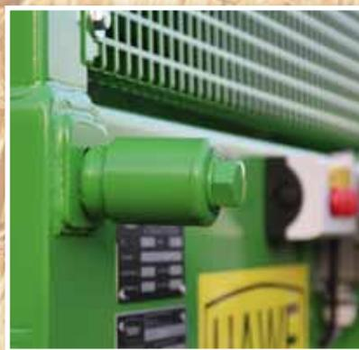
Contrôle visuel de la tension automatique des chaînes.
