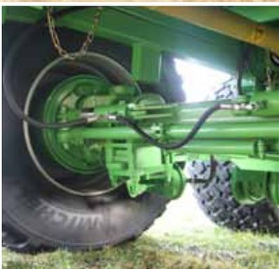
Essieux suiveurs/directeurs verrouillables par commande hydraulique, avec transmission automatique pour un déplacement linéaire optimal.
