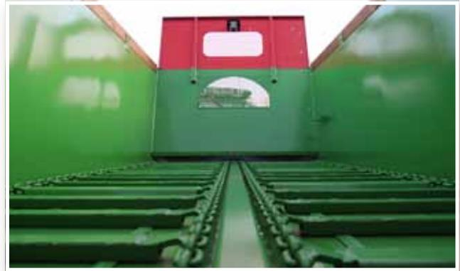
Quatre chaînes de fond, épaisseur 14 x 50 mm, charge de rupture d'environ 25 t par chaîne. Barrettes de fond convoyeur fermées, une barrette sur quatre pour le nettoyage.
