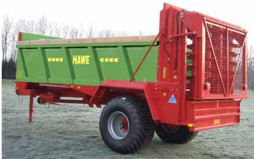
Si l'épandeur est uniquement utilisé pour répandre du fumier, HAWE propose un épandeur à fumier d'une contenance de 7,5 à 19 m<sup>3</sup>. La structure de ces véhicules avec un ou deux essieux est généralement similaire à celle des épandeurs universels. La différence principale est le type d'épandage avec quatre hérissons verticaux. La largeur d'épandage atteint environ 6 mètres. Les couteaux installés sur les hérissons broient parfaitement la matière à épandre.
