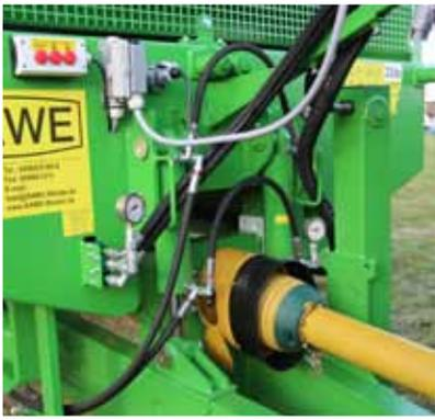
Timon, suspension hydraulique avec attelage inférieur.
