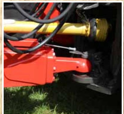
Commande de l'essieu directionnel via un câble Bowden.
