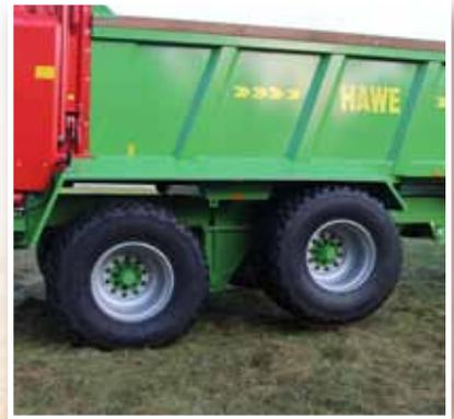
Châssis de bogie avec essieu de levage.
