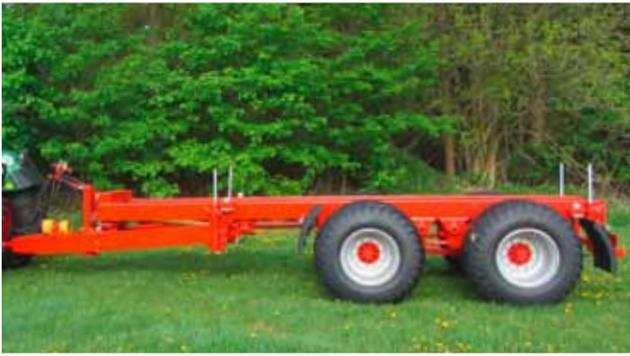
Les remorques SLW de HAWE sont également livrables avec essieux tandem ou tridem pour recevoir des caisses mobiles WPS de différentes tailles. Disposer de plusieurs caisses HAWE différentes permet d'augmenter l'utilisation annuelle des essieux et donc la rentabilité.
