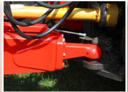
Liaison au guidage forcé par câble Bowden.
