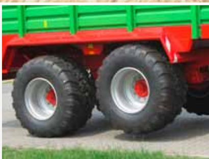
Essieu relevable pour augmenter la puissance de traction si nécessaire et réduire la résistance au roulement sur route.
