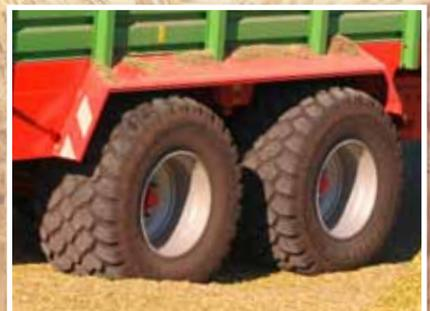
Les gros pneus réduisent la puissance à fournir par le tracteur et évitent la compaction du sol, même dans des conditions pluvieuses de récolte. La grande bande de roulement réduit la résistance au roulement, ce qui permet d'avancer même dans des conditions difficiles.
