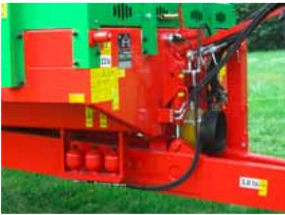
Béquille hydraulique et flèche à suspension hydropneumatique.
