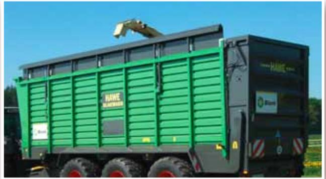
Côtés rehaussables par vérins hydrauliques pour augmenter le volume de chargement.
