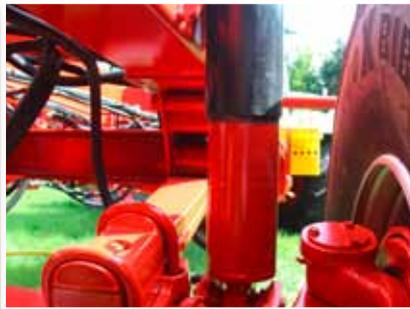
Essieu avec suspension hydropneumatique.
