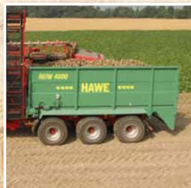
Caisses de bennes pour betteraves de 27 m 3 (tandem) et 40 m 3 (tridem).
