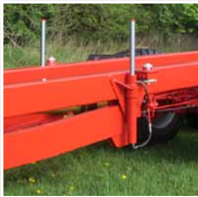
Vérins de levage pour atteler et dételer les différentes caisses.
