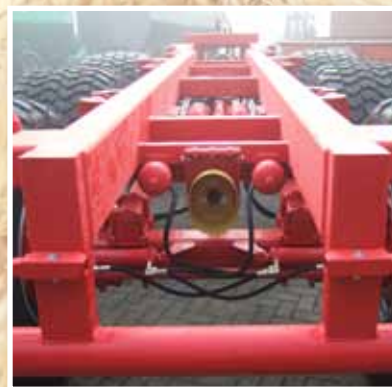
Châssis tridem avec prise de force restituée de série pour la transmission de la caisse.
