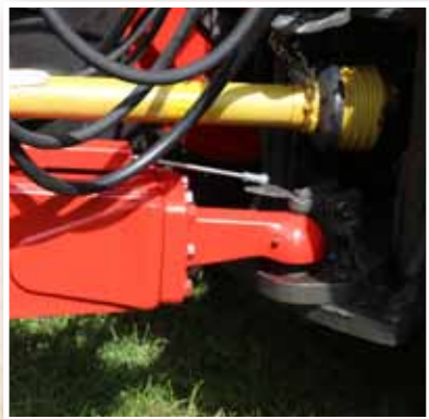
Commande de l'essieu directionnel via un câble Bowden.
