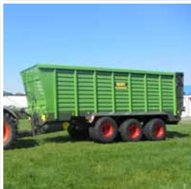
Caisse des remorques à ensilage de 38 à 50 m 3 .
