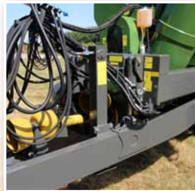
Béquille hydraulique et suspension hydraulique du timon.
