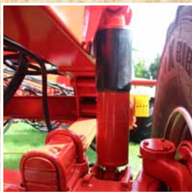
Châssis avec suspension hydraulique.
