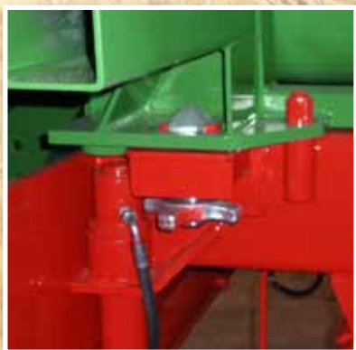
Verrouillage Twist-Lock avec prise pour les béquilles.
