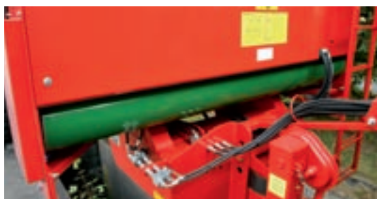
Des moteurs hydrauliques puissants, montés sur la face avant et à l'arrière, enroulent et déroulent le tapis roulant dans un sens ou dans l'autre selon le travail à effectuer.
