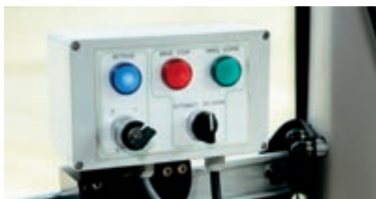
Toutes les fonctions sont activées à partir de la cabine du véhicule tracteur de manière simple et commode à l'aide du pupitre de commande.
