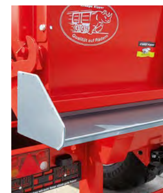
Une tôle d'écoulement peut faciliter le déchargement dans le cas, par exemple, de pommes de terre dans le bunker.
