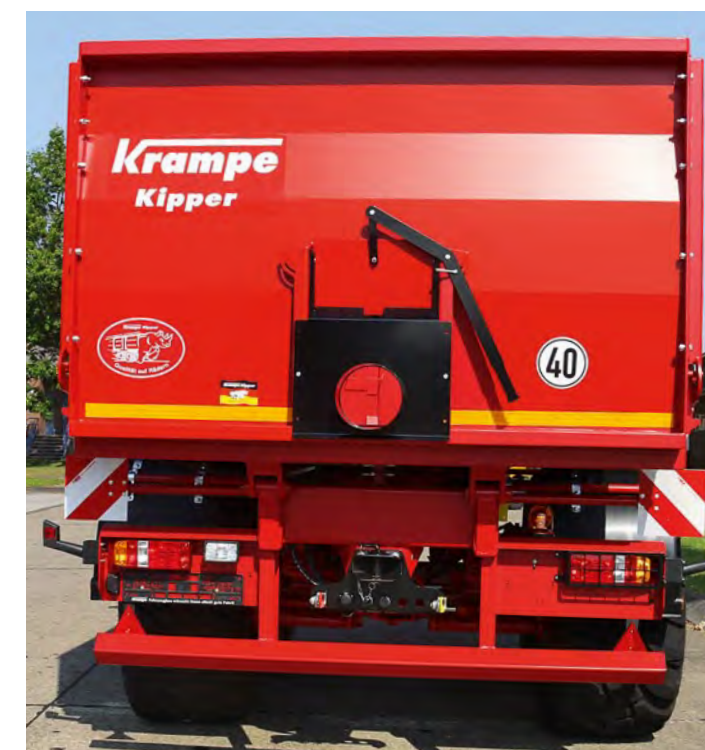
Vue arrière avec dispositif d'attelage automatique, prise d'air et d'huile à l'arrière, grille de protection devant les feux arrière et les feux de position.
