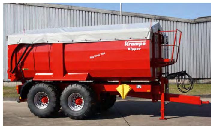
La bâche coulissante est une solution ayant fait ses preuves pour les bennes courtes.
