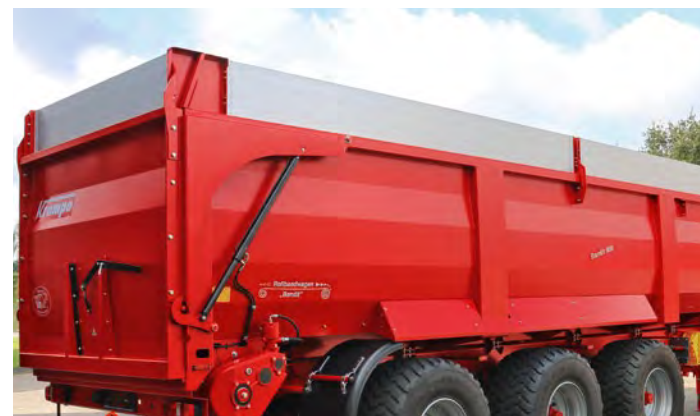
Des rehausses en aluminium de 40 cm offrent un transport de volume plus grand et un poids propre plus faible.
