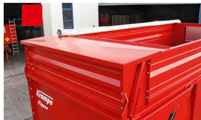
L'utilisation d'une bâche enroulable avec les rehausses d'ensilage est également possible.
