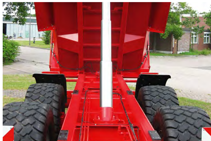
Les cylindres télescopiques sont équipés d'un anneau de cardan et d'une valve de verrouillage. Des entretoisements et des travers apportent la rigidité nécessaire au véhicule.
