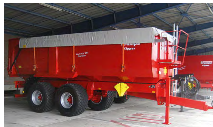
La bâche enroulable peut directement être attachée à la benne de base.
