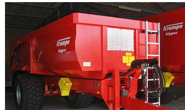
Un bandeau massif plus haut de 200 mm est proposé pour un plus grand volume sans rehausses.
