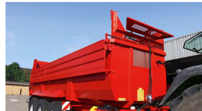
La combinaison de rehausses rabattables latéralement ou à l'avant offre un volume plus grand, une hauteur de chute variable et une bonne vision.
