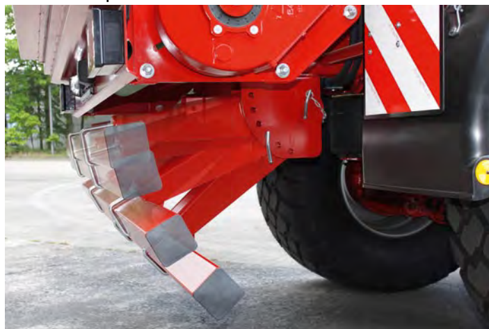
Le dispositif anti-encastrément rabattable en hauteur peut être ajusté en hauteur sans avoir à utiliser d'outils.
