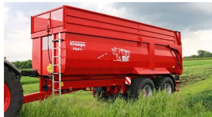
Les rehausses d'ensilage sont fabriquées en ridelles profilées et séparées au milieu à partir d'une longueur de benne de 6,5 m. Elles existent en 50, 60 et 80 cm de hauteur.
