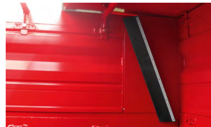
Un joint en caoutchouc rend les rehausses étanches.
