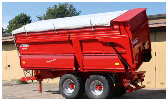
La bâche enroulable est une solution simple et peu chère.
