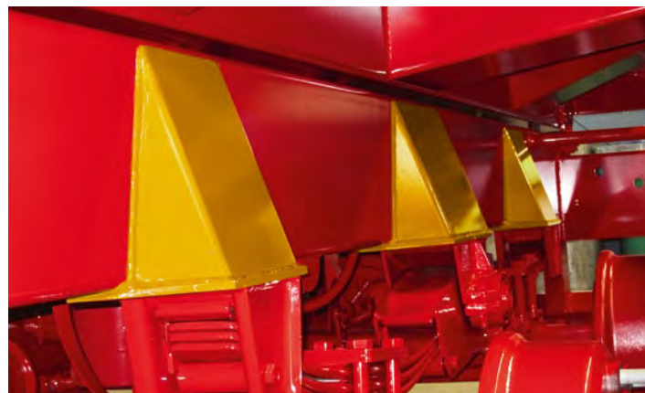
Le large entraxe contribue à une meilleure stabilité sur les terrains mais également pour les véhicules avec centre de gravité haut.
