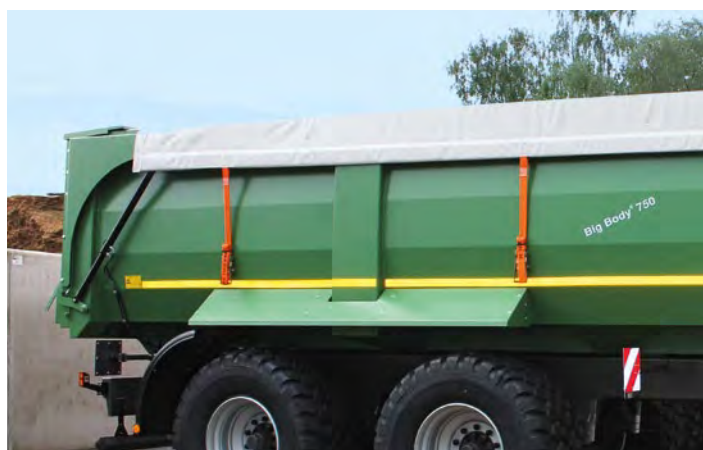
Les bandes réfléchissantes sont souvent obligatoires et également disponibles pour le hayon arrière. La largeur des garde-boues est facilement adaptable aux pneus grâce à un assemblage à vis breveté.
