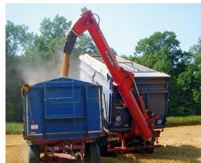
Vis sans fin de transfert latéral avec une capacité de 20 à 300 t/h.
