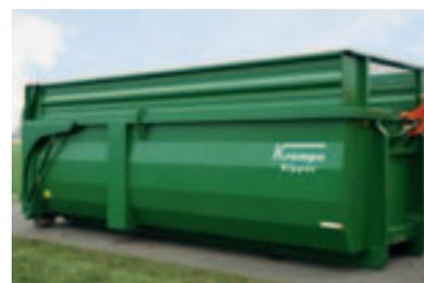
Caisson « Big Body » avec rehausses d'ensilage et hublot d'inspection sur la face avant.
