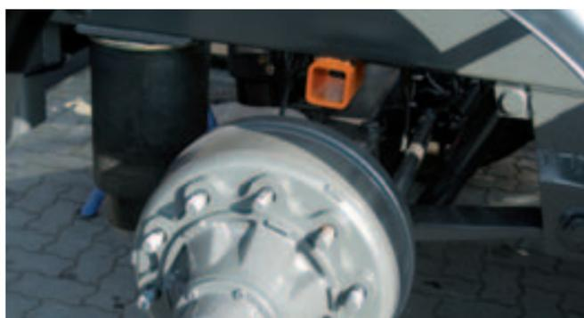
Lors du bennage, comme lors de l'accrochage ou du décrochage, les soufflets de la suspension pneumatique sont désaérés, la remorque repose sur l'essieu arrière. Ceci est la raison pour laquelle nous n'avons besoin ni de support hydraulique d'essieu arrière ni d'un quatrième organe de commande à double effet.
