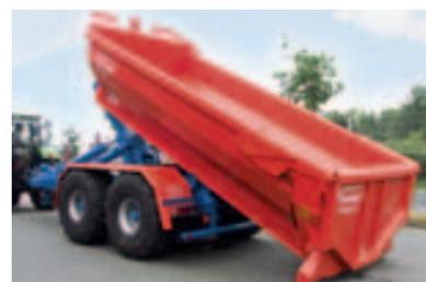
Caisson « halfpipe » avec benne HARDOX et porte hydraulique oscillant.
