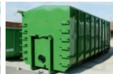
Caisson avec sol séchant pour plaquettes et bois à brûler.
