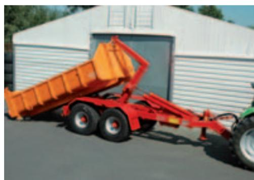
Pour les véhicules prévus à l'exportation, une version avec suspension parabolique et freins hydrauliques en option est disponible.
