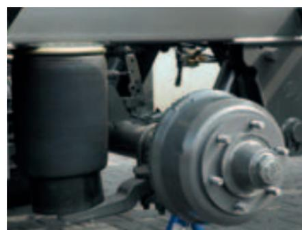
Le châssis à suspension pneumatique s'abaisse automatiquement en levant et en basculant le caisson.
