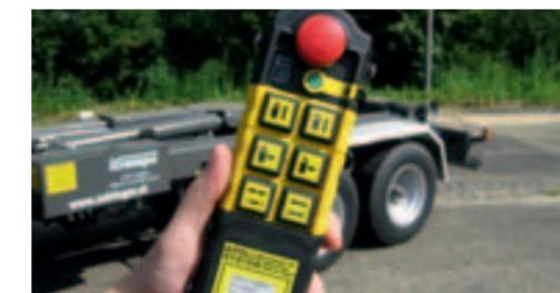
Grâce à la télécommande extrêmement pratique qui a fait ses preuves, les vérins hydrauliques principaux, le bras coulissant et le verrouillage hydraulique des caissons peuvent facilement être manipulés. Pour l'utilisation du système hydraulique, le camion doit être équipé d'un raccordement de renversement et d'un dispositif de retour libre.
