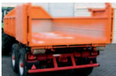
Hayon arrière combiné : hayon oscillant équipé d'une double porte-papillon connu sous le nom de « porte française ».
