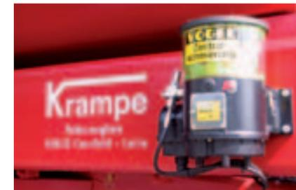
Graissage central : à l'aide de celui-ci, tous les points à graisser seront alimentés en graisse même à des endroits difficiles d'accès tels que par exemple les essieux directeurs.
