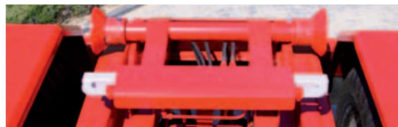
Un verrouillage hydraulique du caisson est un équipement de série (sauf sur la THL 16 Junior). Très important : ainsi des caissons de différentes longueurs peuvent être fixés.
