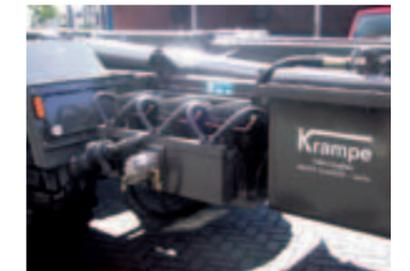
Dispositif de réglage de la pression des pneus.
