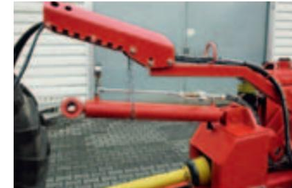
Très bon vérin hydraulique pour le report de poids sur l'essieu avant du véhicule tracteur.
