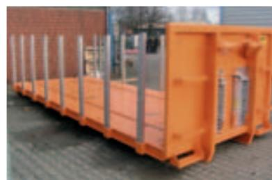
Plateau avec ranches et rampes d'accès en aluminium.
