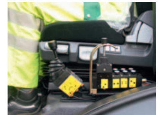
Simple et facile : la commande hydro-pneumatique dans la cabine du conducteur. Une télécommande est disponible contre supplément.
