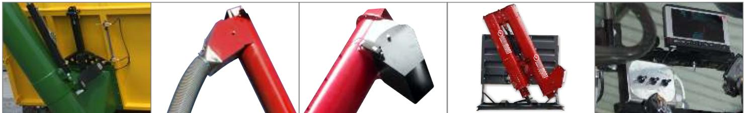
L'entraînement électrique du trappe à grain
