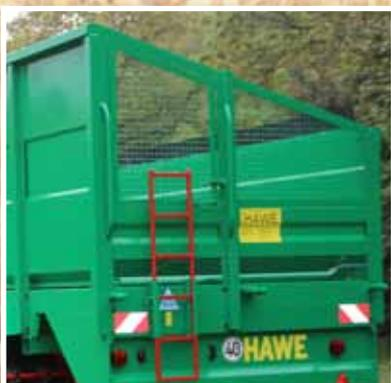
L'échelle de la ridelle arrière permet un accès sécurisé dans la benne RUW pour les opérations de nettoyage.
