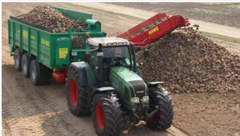
Le tapis de déchargement largement dimensionné de la benne à betteraves HAWE dépose les betteraves sucrières avec rapidité et ménagement sur l'aire du silo. Étant monté à l'avant de la remorque, il permet au conducteur d'avoir une vue dégagée sur le chantier. Une bonne visibilité dans la benne RUW est garantie par sa ridelle avant grillagée.
