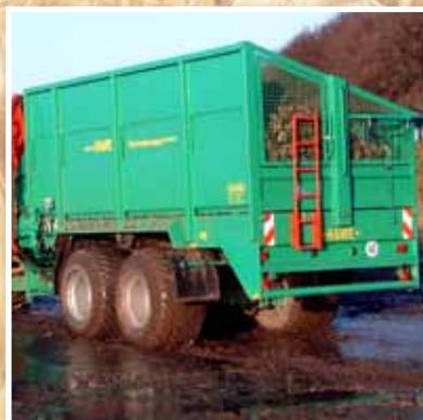
Les pneus grand volume réduisent la force de traction nécessaire et évitent le tassement des sols, même par conditions de récolte humides.
