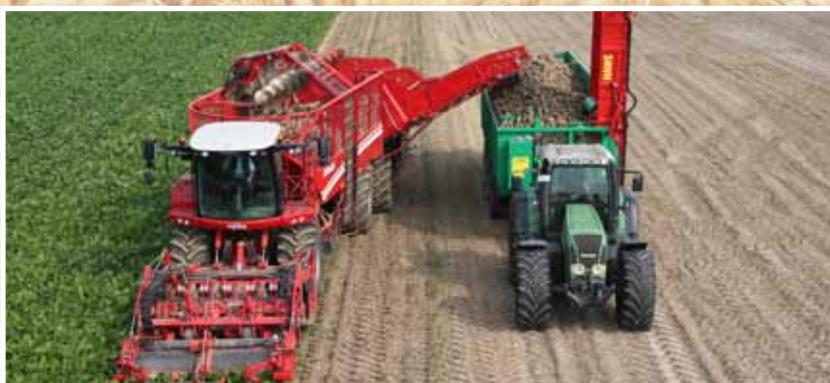
La caisse de la benne HAWE RUW est conçue de manière à permettre un chargement rapide et sans pertes des betteraves tout en roulant. Les deux conducteurs disposent d'un large champ de vision.
