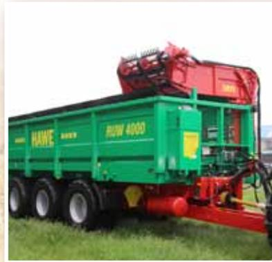
Le tapis de déchargement repliable permet de réduire la hauteur totale de la remorque.
